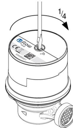
3. Mit einem Schraubendreher die Verriegelung um  $\frac{1}{4}$  Umdrehung rechts herum einrasten.
