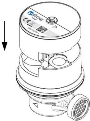
1. Blindkappe vom Wasserzähler entfernen und das Funkaufsatzmodul µflow-skyE einsetzen.
